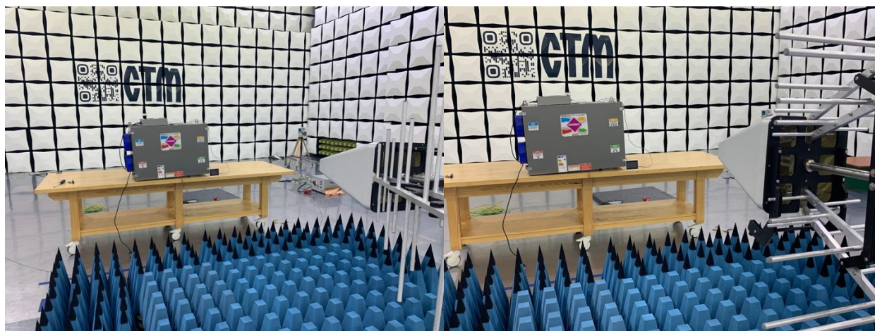
Rys. 8.2.1 Schemat blokowy stanowiska do badań odporności na pole elektromagnetyczne (80MHz ÷ 6GHz)
